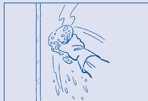
Schoonmaken met zuiver water of neutrale schoonmaakproducten
